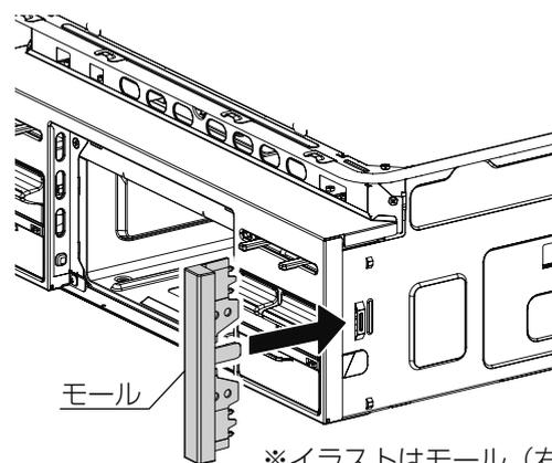
※イラストはモール（右側）を示します。モール（左側）も同様に取り付けてください。
