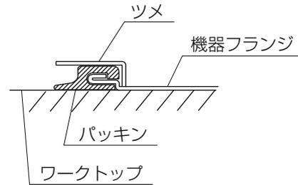
②トッププレートを機器のフランジのツメに引っ掛け、点火プラグを大きな丸穴部分へ通すように取り付けてください。
