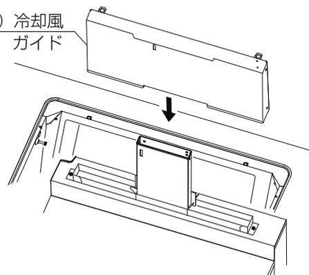
④冷却風ガイドをコンロ側のツメに差し込み、ツメを折り曲げてください。
