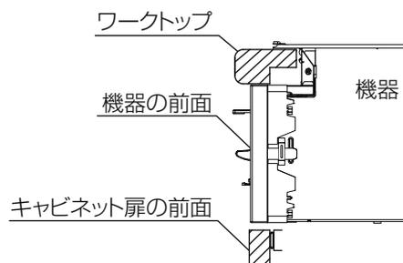
②13ページの ■コンロの設置① でゆるめた六角小ねじ（4本）をワークトップへ機器が動かない程度に固定してください。
