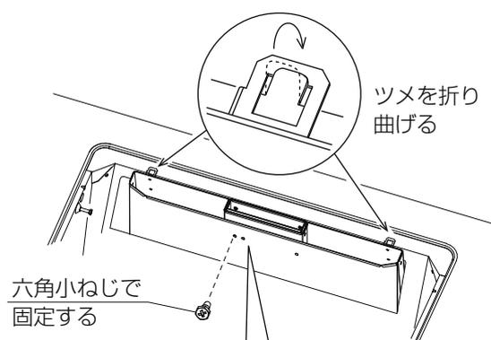
⑤冷却風ガイドとコンビネーションレンジ排気筒を、冷却風ガイドの左穴（穴位置 B）に 26 ページの①で取り外した六角小ねじで固定してください。
