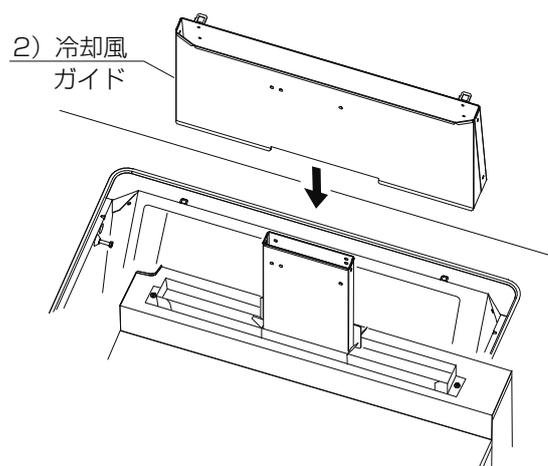
④冷却風ガイドをコンロ側のツメに差し込み、ツメを折り曲げてください。
